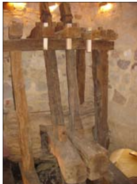
Fig. 10. Esquema de un batán de paños (según S. Pallaruelo, Los molinos hidráulicos del Altoaragón), con indicación de sus componentes: A) Rueda. B) Árbol de levas. C) Levas o álbes. D) Mazos. E) Pila. F) Estante. Y fotografía de los mazos restaurados en las Aceñas de Olivares de Zamora (fot. J. M. Garrido).
