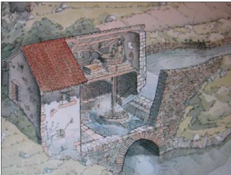
Fig. 7. Esquema de un molino de rampa (según M. Díaz, La molinería tradicional en Las Encartaciones ).
